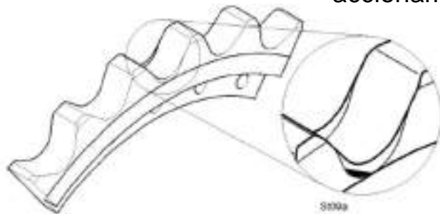
Abb. 4a Typisches Verschleißverhalten am Antriebsrad
