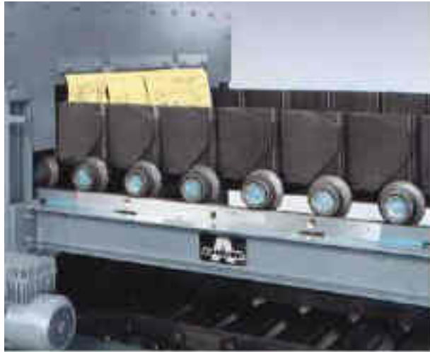
Dosing apron feeder - DPB
