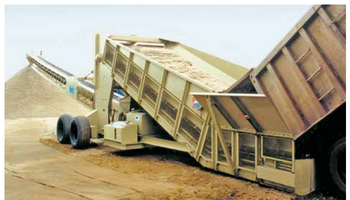
Stormajor™ – Stockpiling Slag
